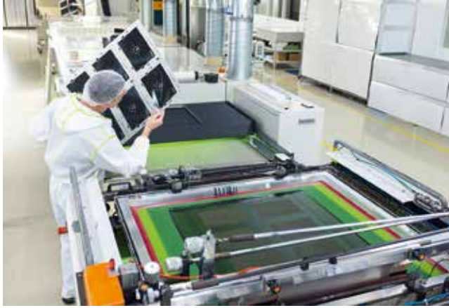
Bild 1. Als Vorstufe zum Film Insert Molding (FIM) bedruckt Heyco die Folien im Siebdruck (© Heyco)
