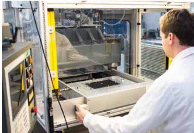
Bild 4. Leiterbahnbreiten und Schichthöhen der gedruckten Strukturen wurden auf Messprojektoren des Typs IM6120 (Hersteller: Keyence) vermessen (© Heyco)
